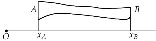
Fig. 12.- Hilo conductor de resistividad y sección dependiente de x .
